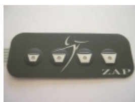
Le clavier "Tactile" Le contact électrique est accompagné d'une sensation tactile.
